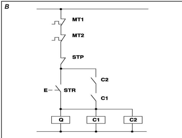
Collegamenti elettrici interni / *Internal electrical connections* / Raccordement électrique internes
