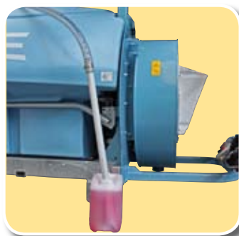
Incorporatore aspirante di prodotti a tubo Incorporateur de poudre avec tuyau Sucking powder system with pipe Spritzmittel füll-Schleuse mit schlauch Chupar sistema de polvo con manguera
