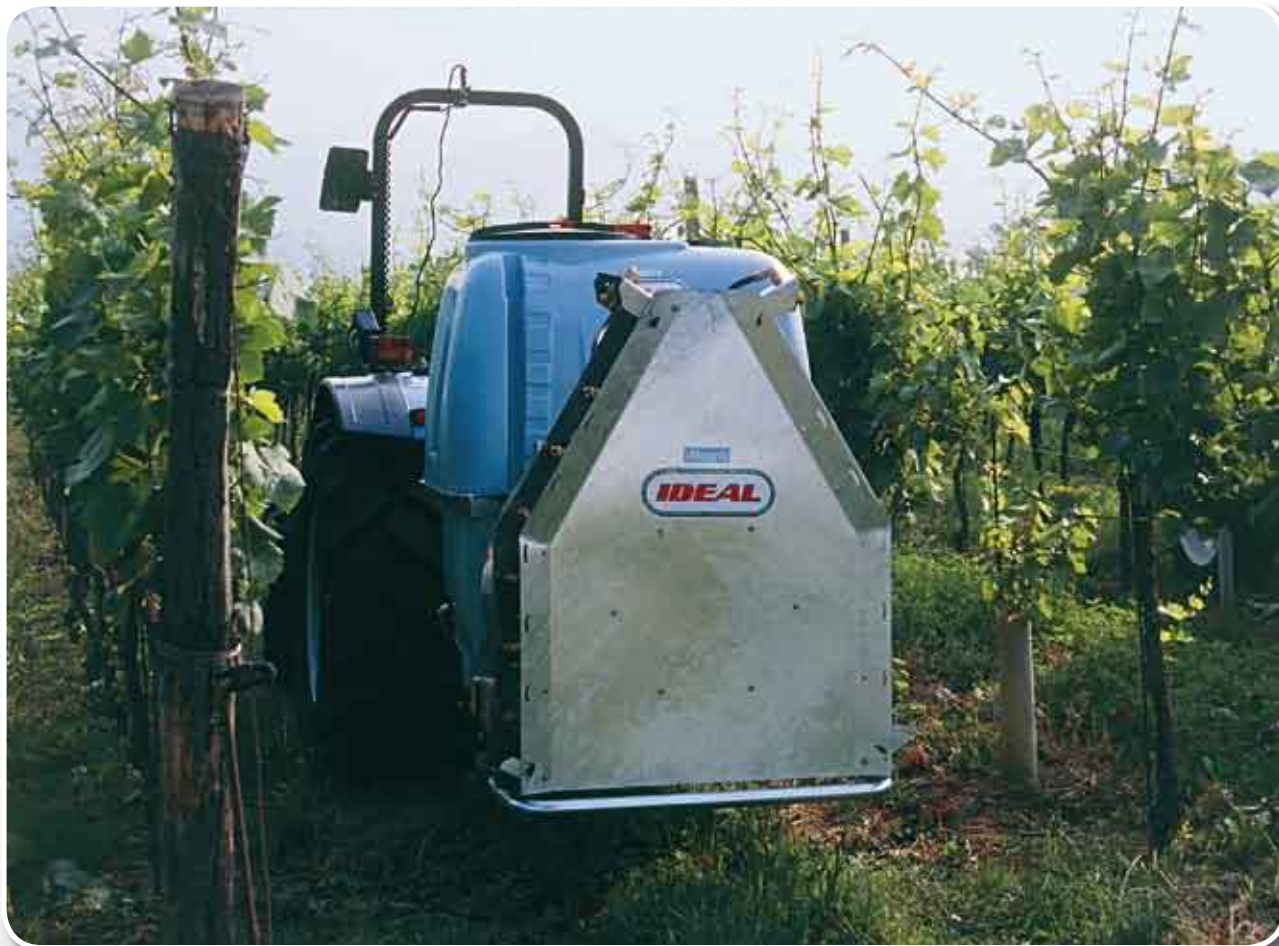
Versione con convogliatore "TOP" per colture a spalliera. - Model with "TOP" conveyor for rows cultivations. Modele avec convoyeur "TOP" pour ranglées. - Version "TOP" Leitblech für Spalier-Kulturen
