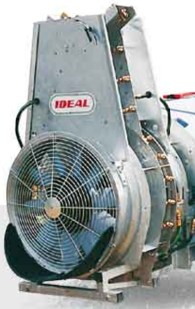
Convogliatore per spalliere Convoyeur pour espalier Conveyor for espaliers Leitblech für Spalier-Kulturen
