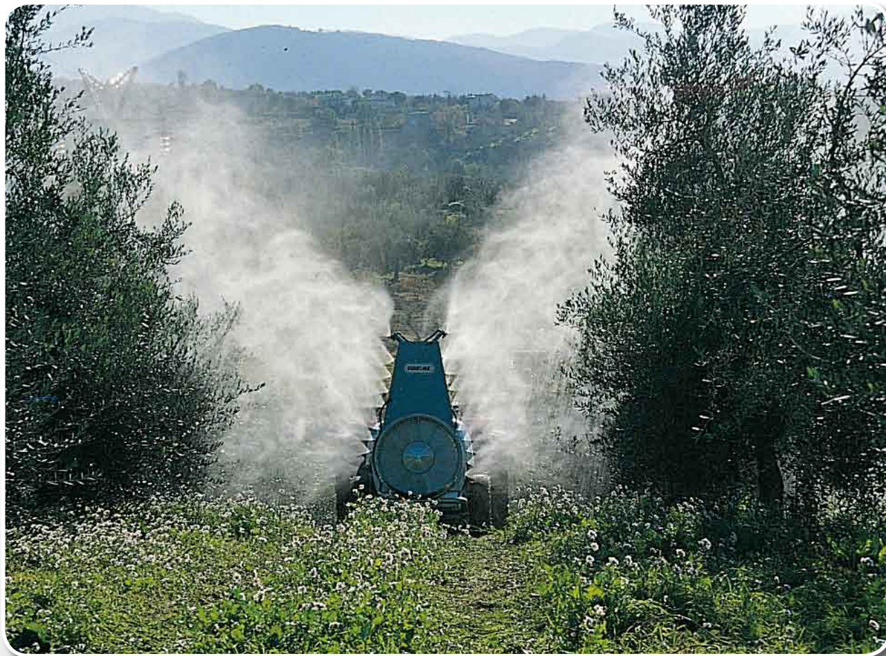
PERFECTION con convogliatore per spalliere. - PERFECTION avec convoyeur pour espalier. PERFECTION with conveyor for espaliers. - PERFECTION mit Leitblech für Spalier-Kulturen
