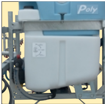
Dispositivo di risciacquo (optional nel modello 300 litri) Rinsing device (optional for model 300 liter) Dispositif de rinçage circuit (option sur modèle 300 litre)
