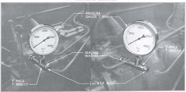
Fig. 61 **D.A.R. Valve Check Valve Test**
