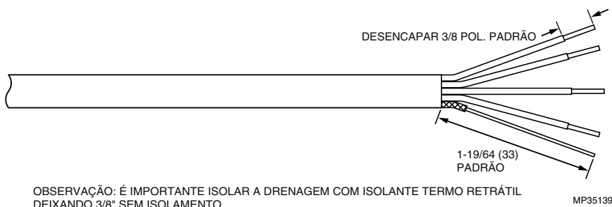
Fig. 5. Preparação do Cabo da Extremidade do Processador de Sinal C330S.
