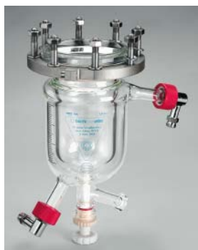
Typ 1 0,25/0,5/1,0/1,6/2,0 l max. 200°/6 (12) bar
