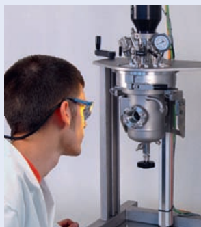
Visual supervision of reaction through sight glass Visuelle Überwachung der Reaktion durch Schauglas
