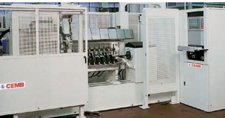
Equilibratrice semiautomatica per alberi a gomito. Correzione squilibrio per foratura.
