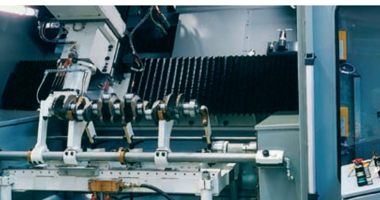
Equilibratrice semiautomatica per alberi a gomito di camion. Correzione squilibrio per foratura.
