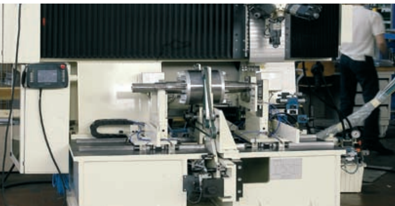
Equilibratrice automatica per rotor di motore elettrico. Correzione squilibrio mediante foratura radiale.
