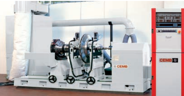
Equilibratrice semiautomatica per compressori di gas. Correzione squilibrio per molatura.
