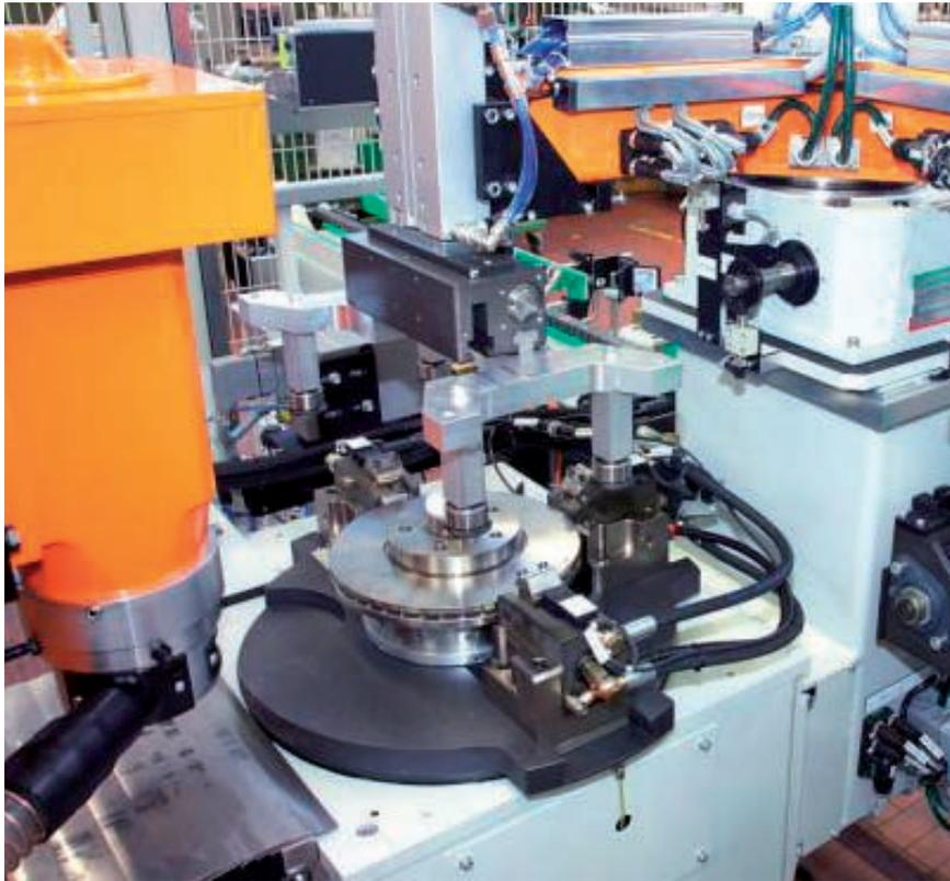
Macchina automatica per equilibratura dischi freni completa di caricatore e unità di fresatura.
