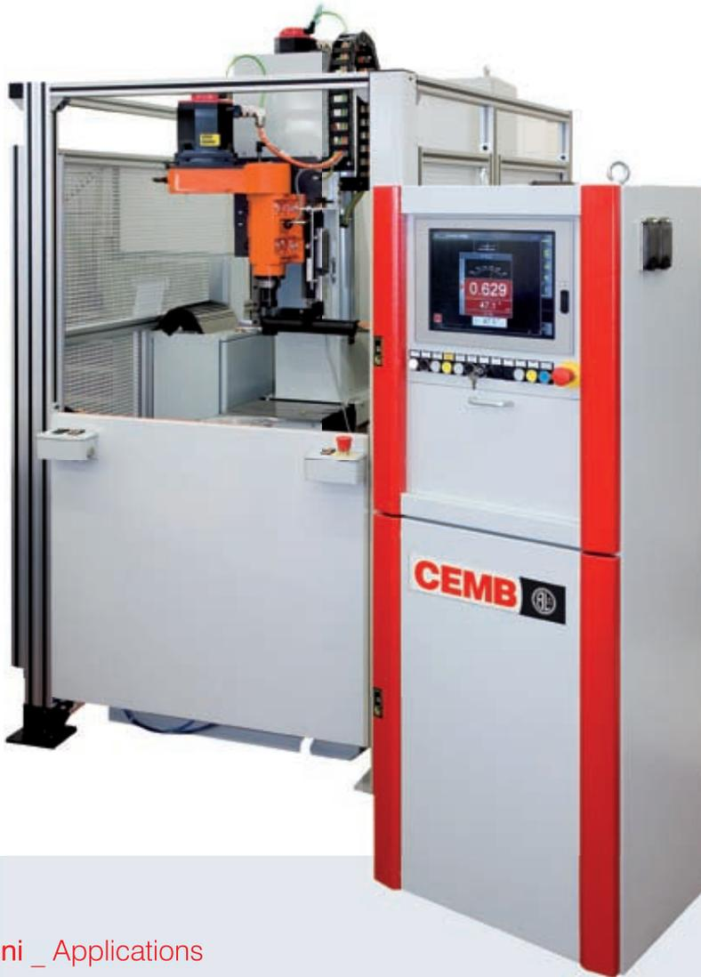
Macchina automatica con unità foratrice ad asse verticale con spostamento radiale dell'unità per facilitare il carico-scarico. Entrambi gli assi sono controllati con CN FANUC.
