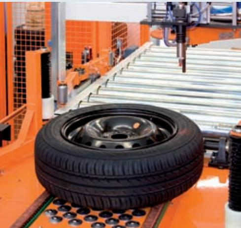
Macchina equilibratrice per ruote autovetture.
