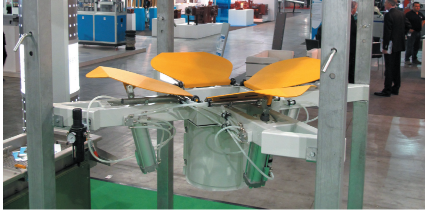
Particolari del sistema di sbattimento per prodotti a difficile scorrimento. Details of the bottom shaking system for difficult flowing products.
