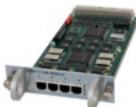
QUAD TI CE RJ45 G.703 I/F TI 1.544MBPS
